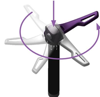
将轴从勾爪上卸下。如欲改变 Maxle Ultimate 快脱杆的闭合位置, 请打开快脱杆, 向下压, 将杆头旋转到理想位置。
